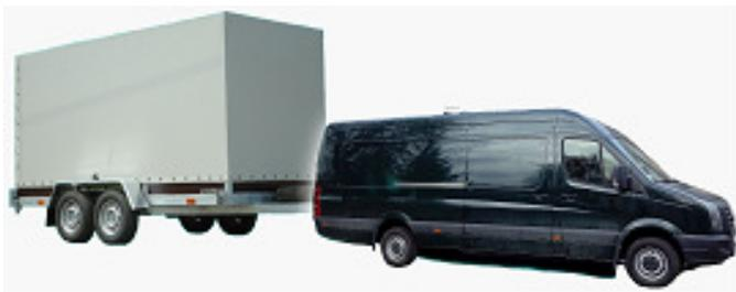
Передвижная поверочная лаборатория ППЛ-330-I предназначена для осуществления поверки измерительных трансформаторов напряжения, выполненных по ГОСТ 1983 и IЕС 60044-2, а также измерительных трансформаторов тока выполненных по ГОСТ 7746 и IЕС 60044-1, для классов напряжения 110-330 кВ, в т.ч. вмонтированных в КРУЭ, на месте их эксплуатации по ГОСТ 8.216-2011 и ГОСТ 8.217-2003 соответственно.
